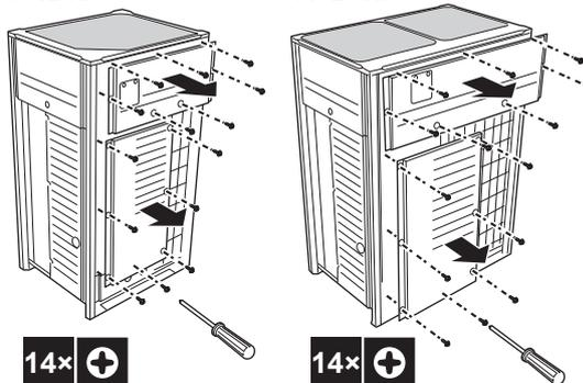
Una volta aperte le piastre anteriori, è possibile accedere al quadro elettrico. Vedere "13.2.2 Per aprire il quadro elettrico dell'unità esterna" [p. 17].
