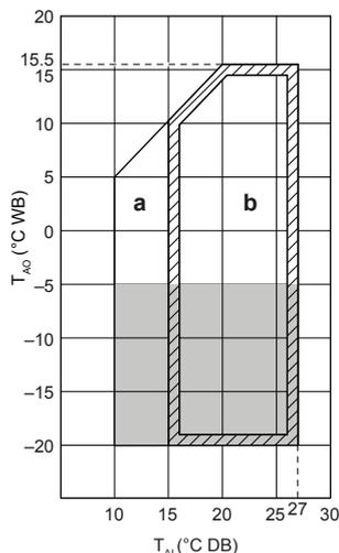
**a** Range di funzionamento in riscaldamento
