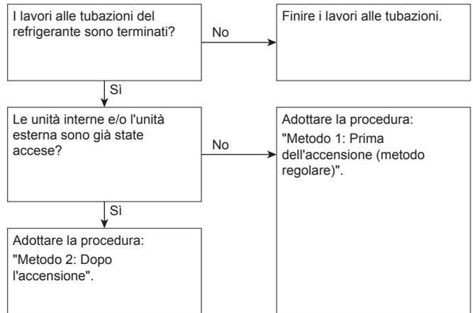
È molto importante che tutti i lavori sulle tubazioni del refrigerante vengano eseguiti prima dell'accensione delle unità (esterna o interna). Una volta accese le unità, verranno inizializzate le valvole di espansione, il che significa che le valvole si chiuderanno.
