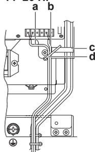
Fissare le staffe di plastica indicate utilizzando morsetti da reperire in loco.
